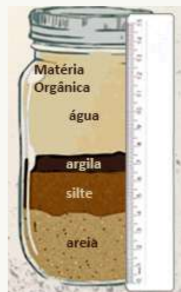
Figura 30: Teste da jarra. Fonte: Adaptado a partir de Milkwood, 2021.
