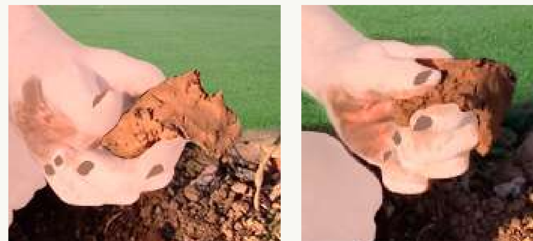
Figura 27: teste de fita. Fonte: Adaptado a partir de Growit Buildit, 2020.
